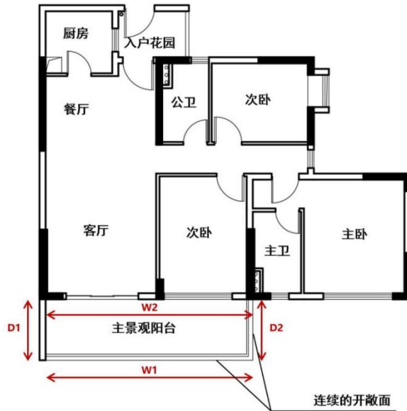
附图2 主景观阳台及阳台连续开敞率示意图
