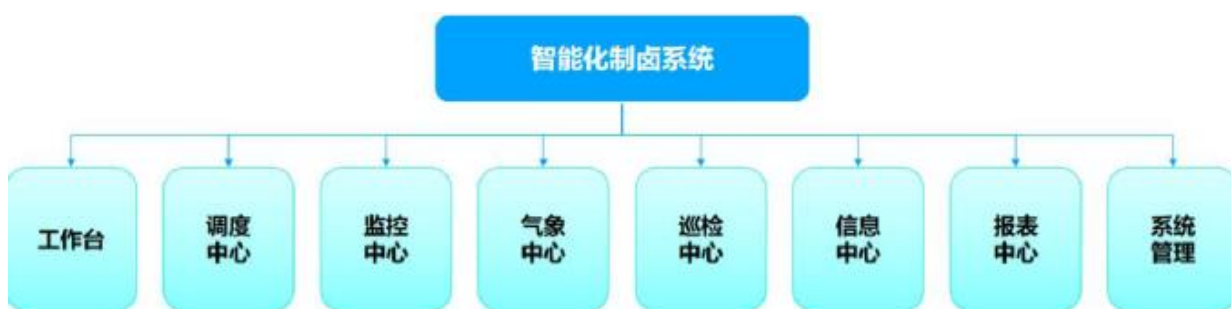
图 2-1 智能化制卤系统云平台架构图
