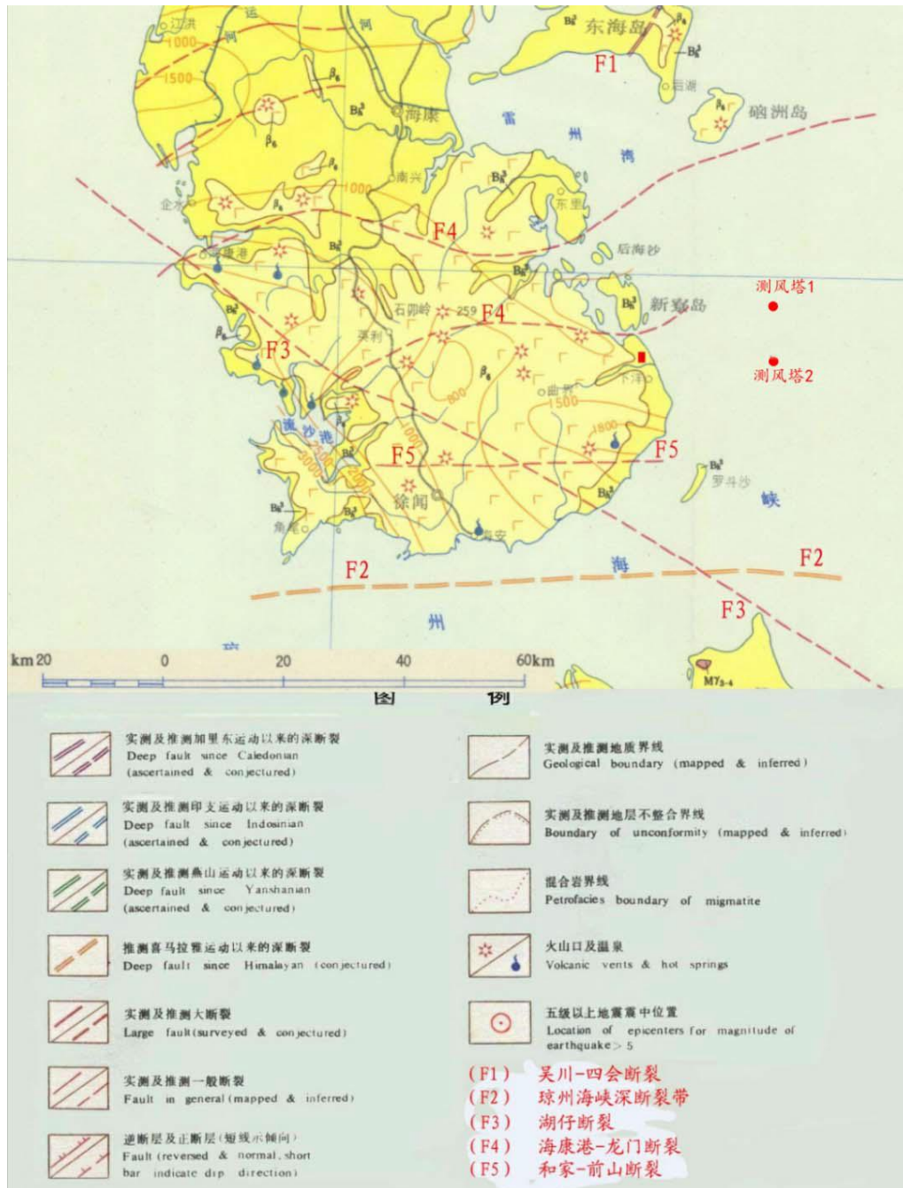
图 3.2.3-3 项目附近区域地质构造图（根据《广东省区域地质志》地质构造图）
